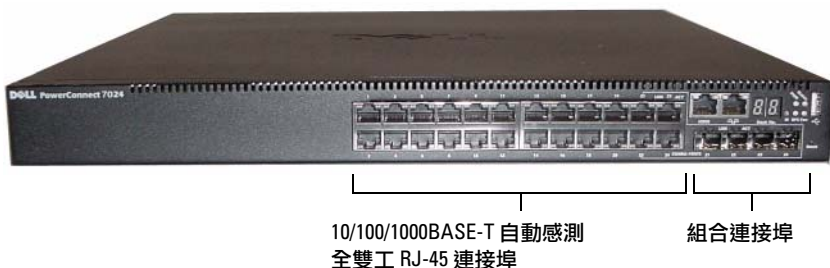
圖 1-1. PowerConnect 7024，具有 24 個 10/100/1000BASE-T 連接埠
