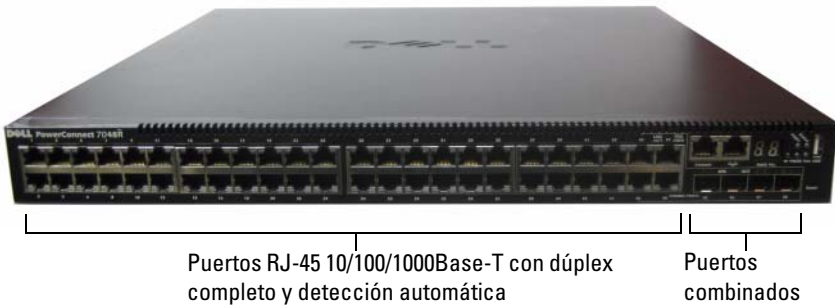
Ilustración 1-6. PowerConnect 7048R con 48 puertos 10/100/1000Base-T
